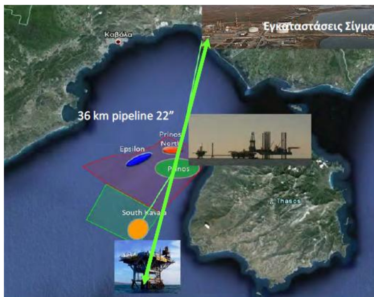
Εικόνα 78: Κοιτάσματα αργού στην περιοχή Πρίνου και η πιθανή διαδρομή αγωγού για την έγχυση ΦΑ στην υπό σχεδίαση υπόγεια αποθήκη του πεδίου Νότιας Καβάλας
